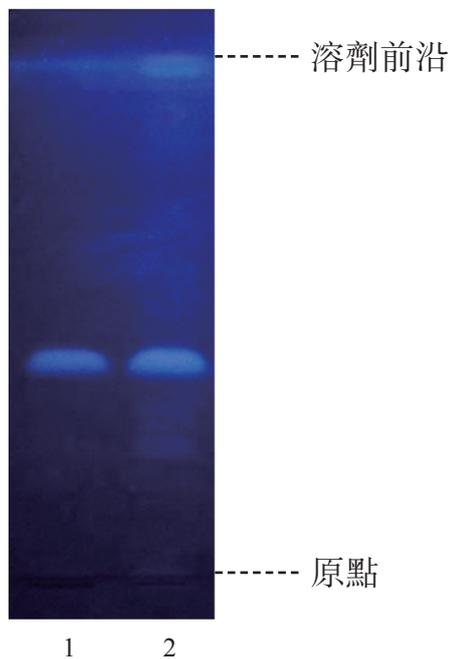
圖5 葎菜子提取液對照高效薄層色譜圖(顯色後在紫外光366 nm下檢視)
