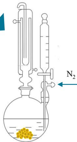
採用 **酸鹼滴定法** 測定藥材樣品中二氧化硫殘留量
